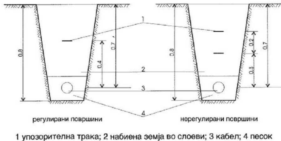
Слика 2-1. Полагање на ОН кабел на рагулирани и нерегулирани површини
