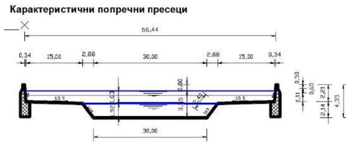
Слика: Попречен пресек на коритото на реката Брегалница кај Штип (градски дел) P=1:100/200
