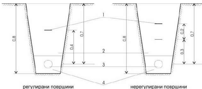
сл. 1. 1-предупредувачка лента; 2-набиена земја во слоеви; 3-кабел; 4-песок
