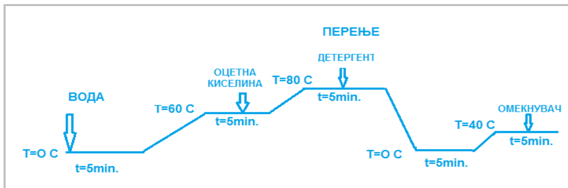
Слика 31 Дијаграм на технолошкоит процес на боење
