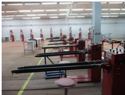
Слика 16 Робусна машина за хоризонтално стругање
