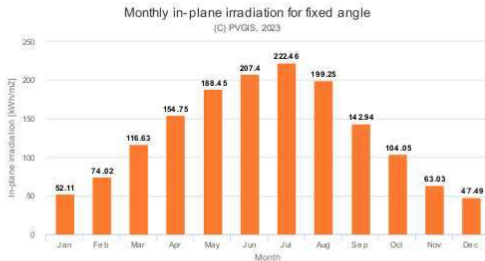
Слика 5.. Просечна ирадијација при фиксен агол за дадената локација изразена во во kWh/m 2
