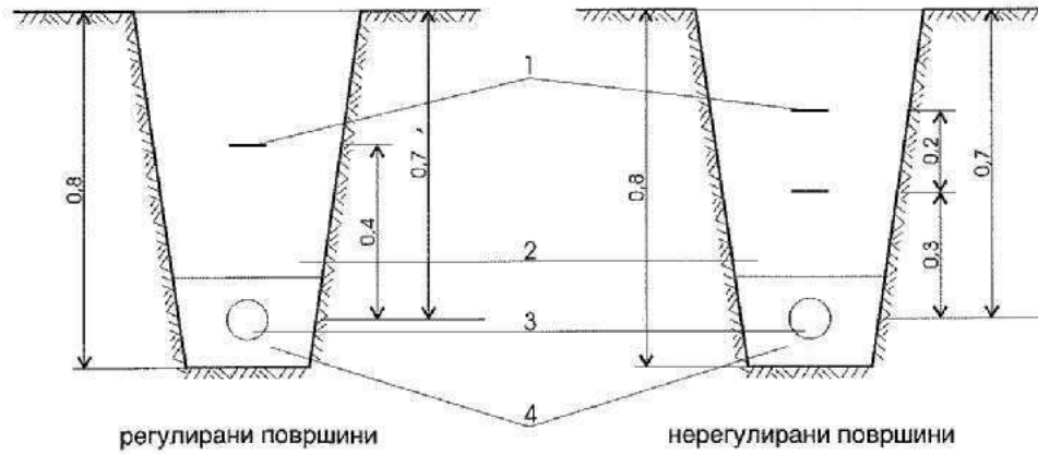
Слика 2-1. Полагање на НН кабел на рагулирани и нерегулирани површини
