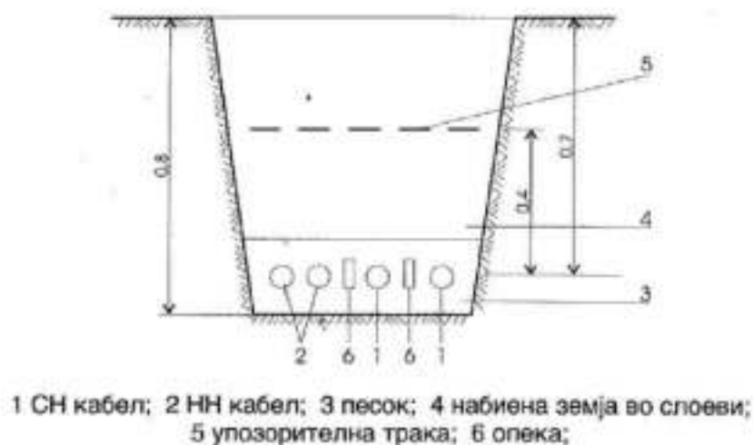
Слика 2-2. Полагање на повеќе кабли во ист ров
